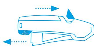
Desplace el dispositivo de seguridad hacia la posición trasera para que la palanca pueda soltarse nuevamente. **Luego** vuelva a introducir en el mango el botón de cambio de cuchilla y siga cortando.
