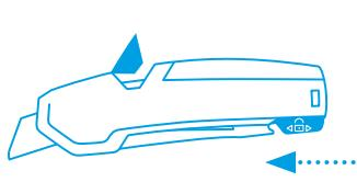
Sujete la palanca con el dispositivo de seguridad y gire el mango de manera que la **cubierta transparente de la hoja** mire hacia arriba.
